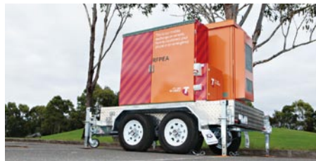
2011年にQLD州南東部を襲った洪水時にも稼働したテルストラの災害用移動基地局（MEOW）。同社は営利事業だけではなく遠隔地の公衆電話の運営などユニバーサル・サービスの責務も担っている
