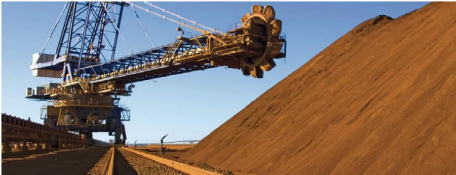
クラウドブレイクにある精製施設。露天掘りの鉱山で採掘された鉄鉱石がここで全長3キロ近い貨物列車に積まれる。263キロ離れたポート・ヘッドランドの港湾施設に運ばれ、中国に輸出される (Photos: Fortescue Metals Group Limited)
